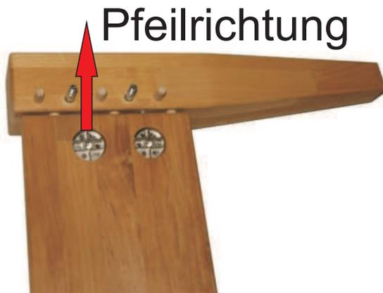
4. Nun drehen Sie beide Exzenter im Uhrzeigersinn abwechselnd fest zu. Der Fuß wird durch das Schnecken-gewinde fest an die Zarge (Seite) herangezogen.
