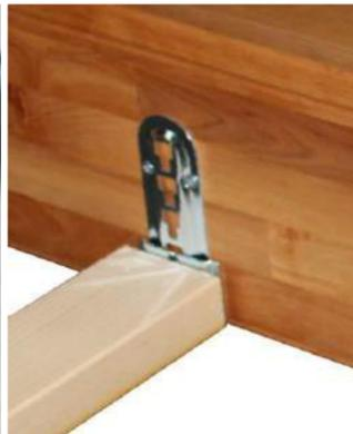
Das Kopfteil mit Steckverbindung wird einfach aufgesteckt, das mit Schraubverbindung wird von hinten ins volle Holz der Bettzarge geschraubt (ohne Vorbohrung! Sonst sinkt die Schraubenauszugsfestigkeit, und das ist bei einem Kopfteil unerwünscht.)
