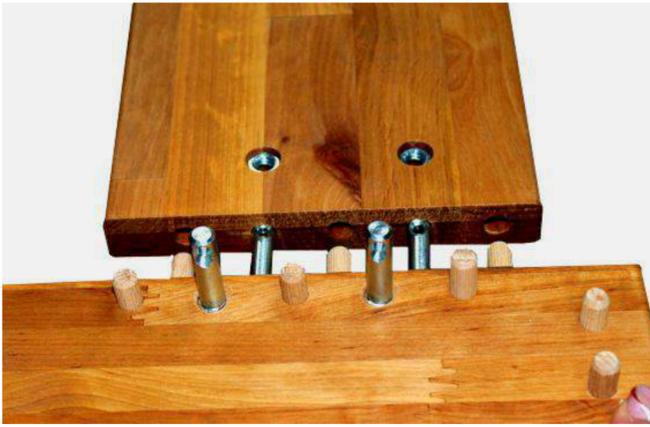
die dicken Madenschrauben aus hochfestem Stahl von oben in die Zylinder schrauben
